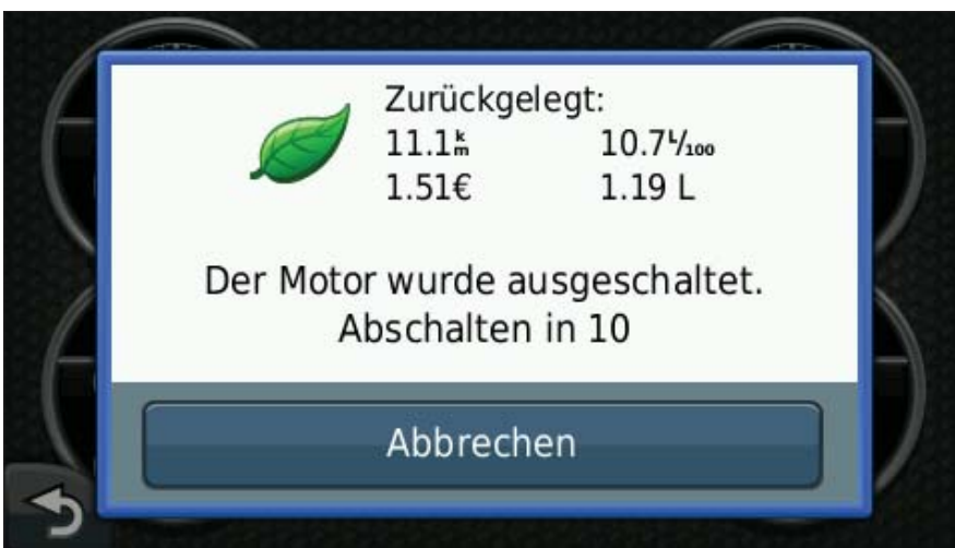
Am Ende einer Fahrt schaltet sich das Elektronikmodul selbstständig ab. Das nÜvi zeigt dann noch die Streckenlänge, den Spritverbrauch und die tatsächlichen Treibstoffkosten.
