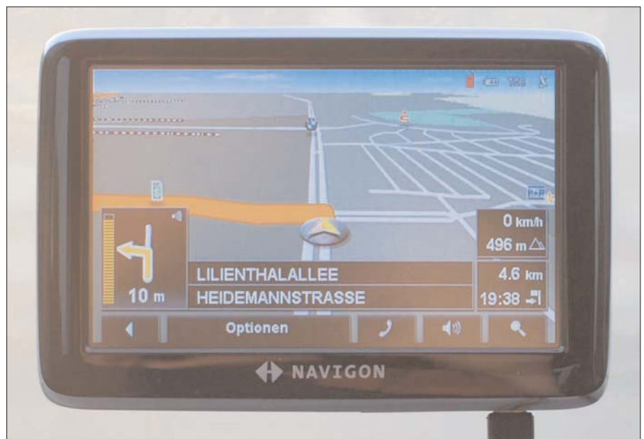
Am linken Bildrand sieht man ein Icon für die nächste Aktion, die Entfernung bis dahin in Metern und den sogenannten Näherungsbalken. Je näher Sie der Abbiegung kommen, desto mehr füllt er sich.
