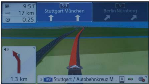
Hier sieht man den Fahrspurassistent Pro 3D kurz vor dem Münchner Nordkreuz. Die Beschriftung der blauen Schilder stimmt nur grob, hier sind andere Hersteller weiter.
